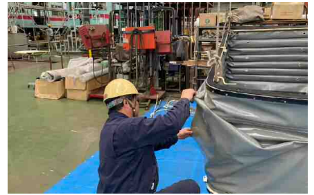
連結幌の整備
